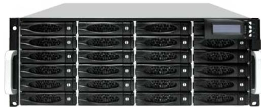
EP-4246J/JD-SCSC 硬碟擴充機箱，在機架式的4U空間中每個機箱可安裝24顆可熱插拔的 SAS3 / SATA3 的硬碟，且採用LSI的DataBolt Bandwidth Optimizer (EDFB) 技術，可緩存 6Gb/s 的資料並傳輸到主機端的12Gb/s 頻寬，以提昇傳輸速度較慢的6Gb/s SAS或SATA 硬碟，享受更快速的傳輸速度。EP-4246J/JD-SCSC 硬碟擴充機箱是一個高性能模組化伺服器存儲解決方案，全模組化設計(Cable-less/ Modular Design)，為用戶提供了強大的可擴展性。獨創的整體性散熱考量及控制方法，EP-4246J/JD-SCSC 硬碟擴充機箱將電源供應器和散熱風扇整合在同一模組中，除可節省機箱的空間外，同時可快速的將系統及電源供應器產生的熱經由高效率風扇散熱。
