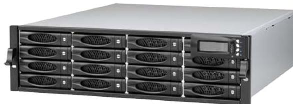
EP-3163 系列的磁碟陣列容錯系統提供了新一代的容錯方案，採用了高速Serial Attached SCSI(SAS/3Gb) 介面及光纖(FC-AL/4G)介面作為主機端(Host)連接的兩種選擇，可在3U的機架空間內安裝高達16顆可熱插拔的SAS / SATA II的硬碟。提供了高容量、高效能及高擴充性的優異特色。為提升的企業對儲存設備的信賴度，除支援磁碟陣列等級0, 1, 10(1E), 3, 5, 6, 30, 50, 60, JBOD外，全系列並支援雙控制器(Dual Controller)以提供更好的容錯能力，實現企業對資料儲存的要求。
