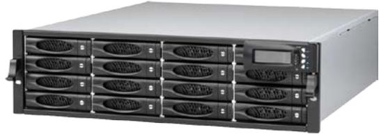
EP-3163系列的磁碟陣列容錯系統彈性地配備8Gb FC-AL光纖、16Gb FC-AL光纖及12Gb SAS介面作為主機端(Host)連接選擇，可在3U的機架空間內安裝高達16顆可熱插拔的SAS2 / SATA3的硬碟，並可串接高達256顆硬碟，提供高效能、高容量及高擴充性的優異特色。EP-3163D2系列提供雙控制器(Dual Controller)以提供更好的容錯能力和更高的可用性，滿足企業對資料儲存的全面要求。
